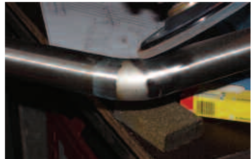
El perímetro completo de la unión sólo puede ser pretratado con abrasivos de disco de láminas.
